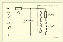
Легко видеть, что R1 — тот же балластный резистор, но конденсатор С1 здесь компенсирует индуктивную составляющую тока первичной обмотки, поэтому мощность, выделяемая на балластном резисторе, меньше 30...50%. Амплитудное напряжение на конденсаторе С1 даже в момент включения не превышает 200 В.
