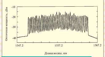
Рис. 5. Оптический спектр 50-канальной линии после 1655 км
